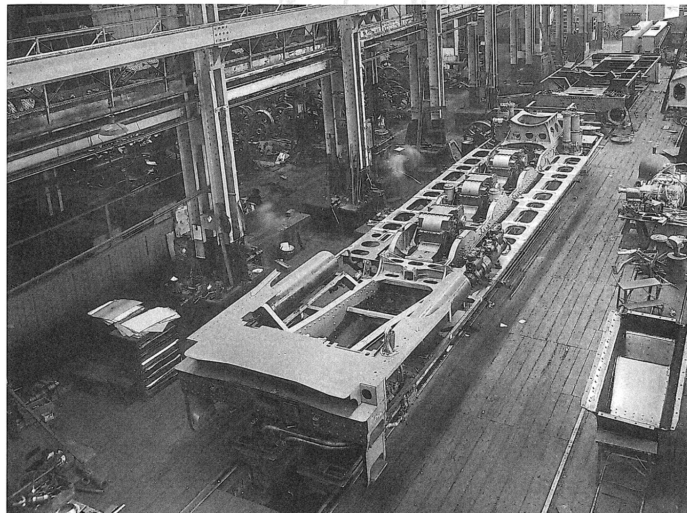
C'est presque la même photo, mais avec les transmissions montées dans le châssis. On distingue à droite deux des moteurs et le cendrier. Page précédente : l'engin vu de profil, dépourvu de la plus grande partie de son carénage. Photos collection Jean-Pierre Cantet.
