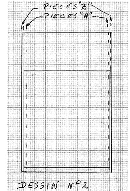
pièces chacun, l'une recouvrant partiellement l'autre de façon à ménager un creux destiné à recevoir les volets (dessin n° 1). Ces deux flancs seront ensuite collés sur leur embase (pièce C), selon les dessins n° 2, 3 et 4. Ils recevront ensuite l'élément E (dessin n° 4 bis), qui représente le radiateur ; dans le cas du 030-DC-1, il ne faudra évidemment en mettre qu'un, du même côté que l'échappement. Mais nous reparlerons de l'échappement quand il sera question des finitions.
