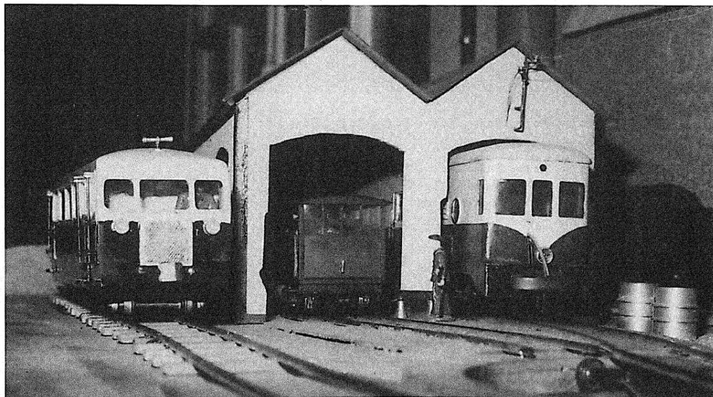
Le matériel a été entièrement construit dans les ateliers du réseau, moteurs, réducteurs, etc. .A l'exception de quelques roues achetées à l'état brut
