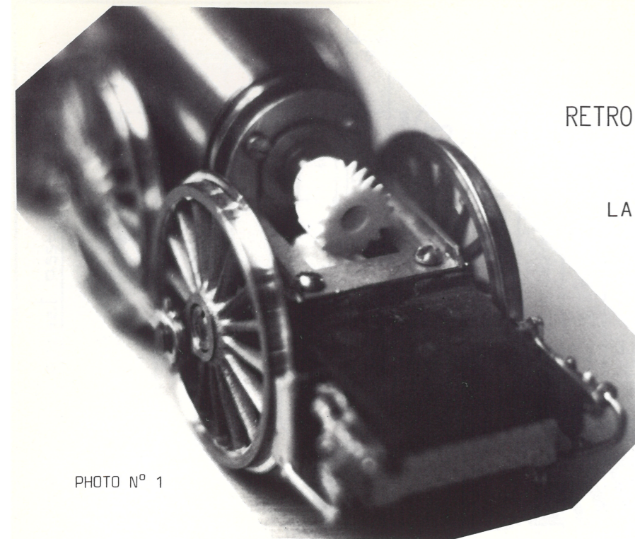
PHOTO MONTRANT LE RENFORCEMENT DU BERCEAU MOTEUR
